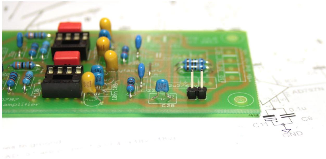
Переходим к разъёмам. Формируем блок в 5 контактов. Совмещаем гребенку и паз двухконтактного и трехконтактного разъёмов.
