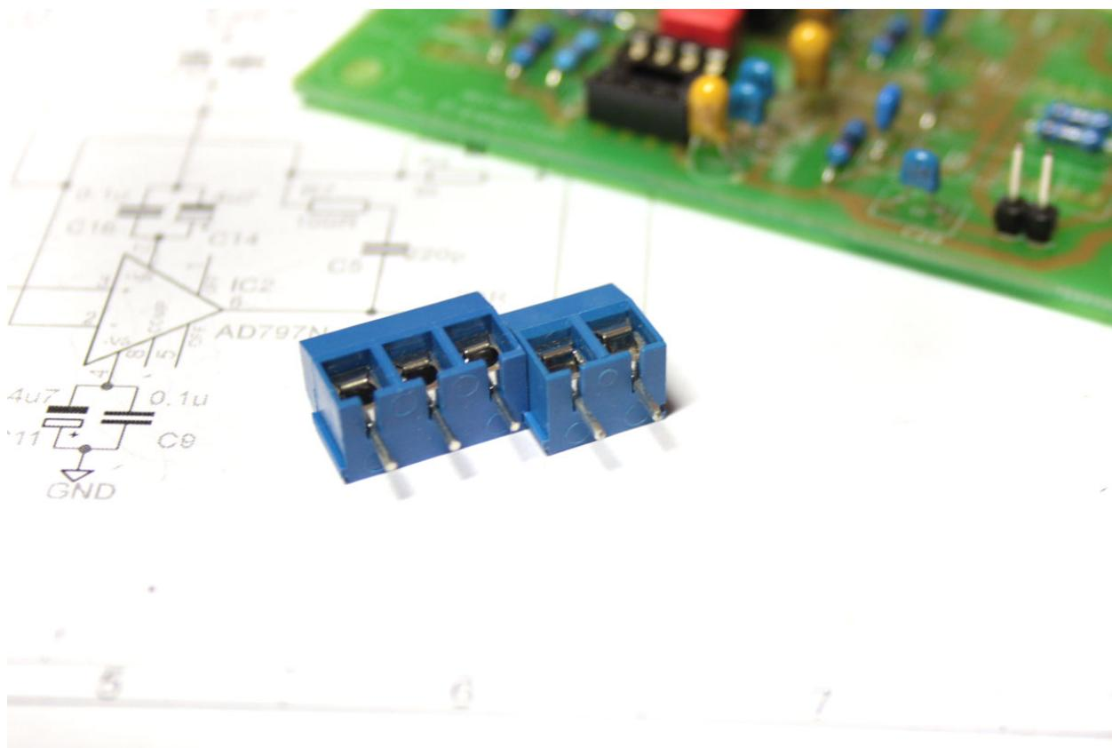
Сдвигаем. Получаем блок в 5 контактов.
