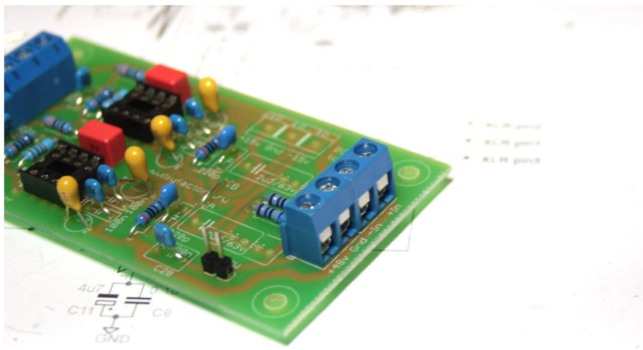
Оставшийся трехконтактный разъём используем для подключения питания.
