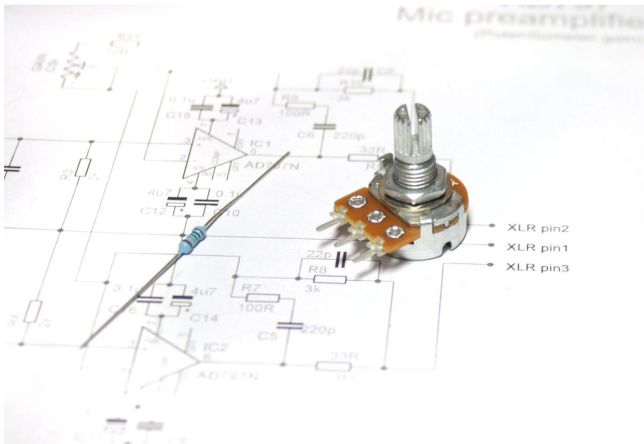
Паяем перемычку между центральным выводом потенциометра и крайним левым выводом. Используем обрезок вывода резистора.
