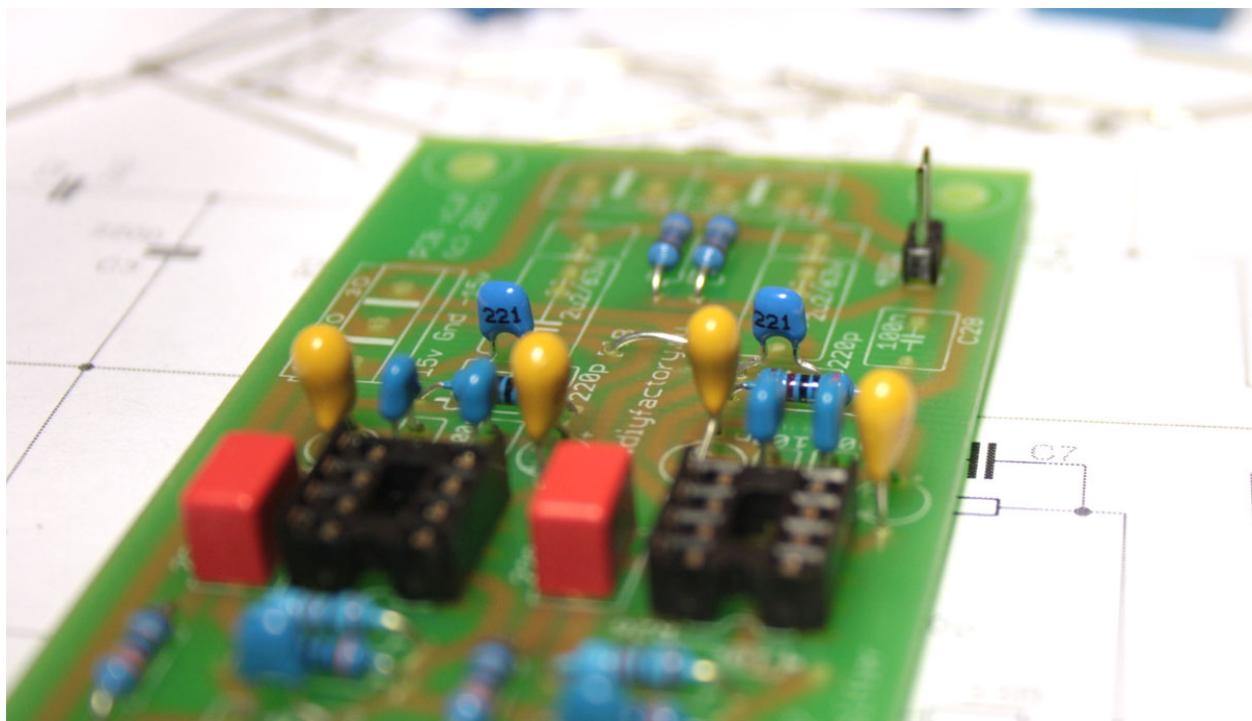
И конденсатор в цепи фантомного питания 100n (0.1u) – C28 (на схеме не обозначен).
