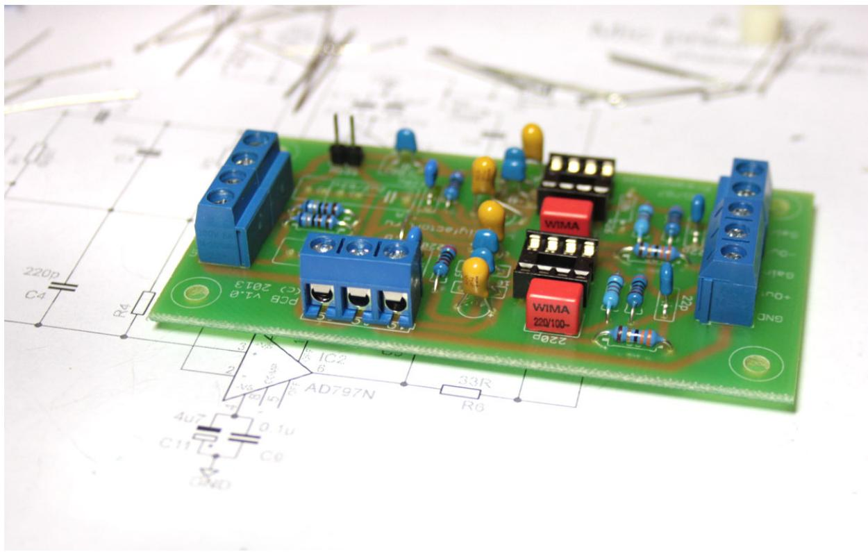
Монтируем два полипропиленовых конденсатора номиналом 2u2 (C1, C2). Плата позволяет использовать конденсаторы с расстоянием между выводами от 7,5мм до 15мм.
