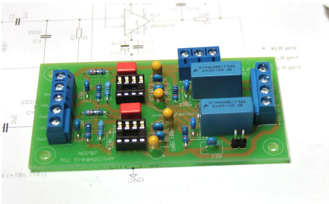
Вставляем микросхемы. Обращаем внимание на то, как микросхемы ориентированы на плате, на расположение «ключа».
