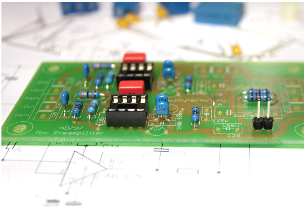
Далее следуют четыре tantalовых конденсатора. Обращаем внимание, как конденсаторы ориентированы на плате. Плюс конденсатора обозначен на корпусе полосой и соответствующим знаком. Важно не перепутать полярность, будьте внимательны.
