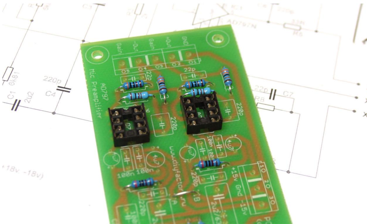
С одной стороны у панелек есть выемка, которая обозначает сторону, с которой у микросхемы расположен «ключ». См. фото.
