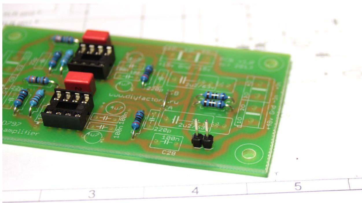
Паяем два конденсатора по 22p (C3, C4).
