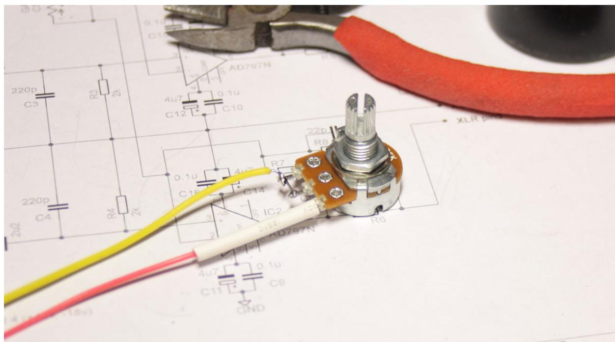
После того как мы закончили монтаж, осталось подключить питание (для питания схемы необходим блок питания, обеспечивающий двухполярное постоянное напряжение +15в, -15в), провести соединение регулятора гейна и входного и выходного гнезд. После сборки наладка схемы не требуется, работает сразу.
