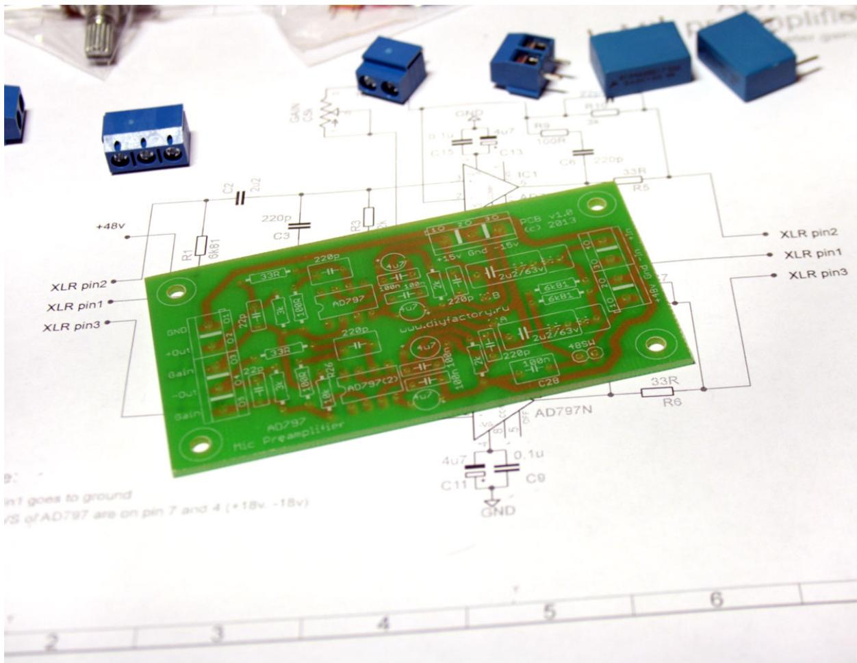
Монтаж элементов на плате начинаем с резисторов перемычек.
