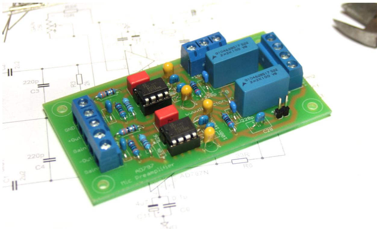
Монтаж основной платы закончен. Осталось провести монтаж регулятора гейна.
